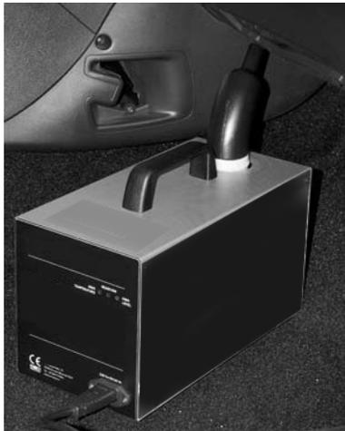
Starten Sie den Motor und stellen Sie das PureZone Gerät auf den Fahrzeugboden der Beifahrerseite. Platzieren Sie das Förderrohr so dicht wie möglich an die im Bodenraum befindliche Luftzirkulationsöffnung.
