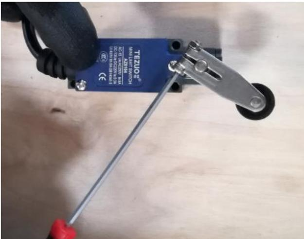
Montieren Sie den Endabschalter in der Säule (Motorseitig)
