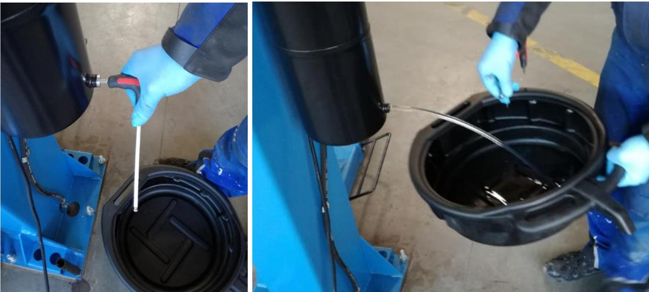
Wenn das Öl abgelassen wurde, entfernen Sie jeweils die 4 Sechskantschrauben die den Tank befestigen.
