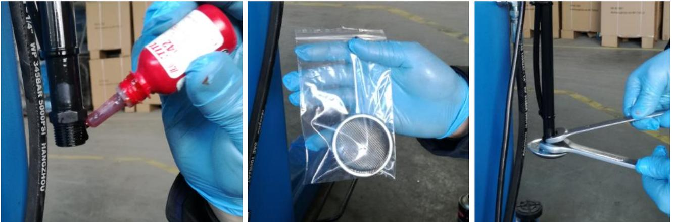
Entfernen Sie nun den alten O-Ring am Hydraulikblock und ersetzen diesen durch den neuen O-Ring.
