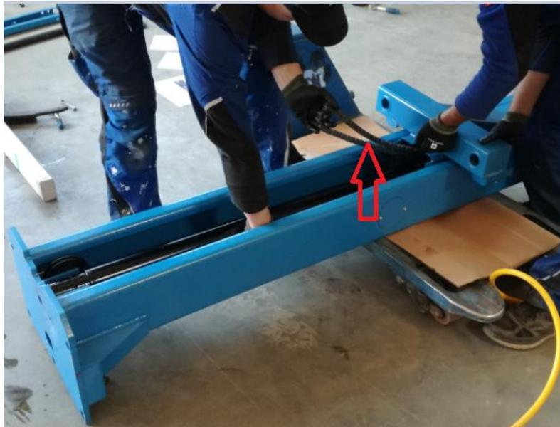
Montieren Sie die Kettenabfallsicherung.
