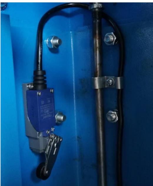
Schließen Sie nun das Kabel von Spiralkabel zur Steuerbox an und verlegen dieses über die Traverse zur Steuerbox. Verlegen Sie auch das Endabschaterkabel von der Traverse zur Steuerbox.
