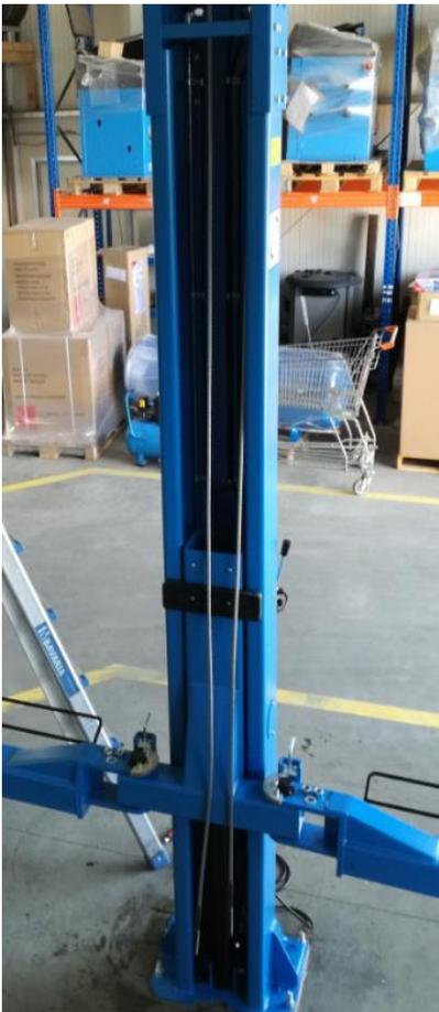
Demontieren Sie die untere Seilrolle und Seilabfallsicherung. Schmieren Sie die Seilabfallsicherung und ziehen das Stahlseil um die Seilrolle. Befestigen Sie nun wieder die Seilrolle. Führen Sie diesen Vorgang auch an der zweiten Seite durch.
