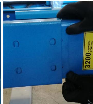
Schrauben Sie die Säulenverlängerung leicht an sodass die Verlängerung noch bewegt werden kann. Die am Bild rot markierten Pfeile zeigen an, welche Schrauben jeweils an der Rückseite bzw. seitlich eingeschraubt werden.
