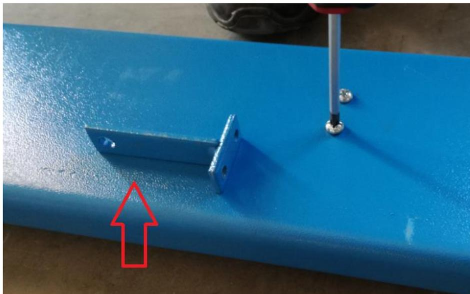
Montieren Sie den Halter für den Endabschalter, danach montieren Sie den Enabschalter. Verlegen Sie das Kabeln durch den Gummikanal. Versteuen Sie das Kabel im Inneren der Traverse.
