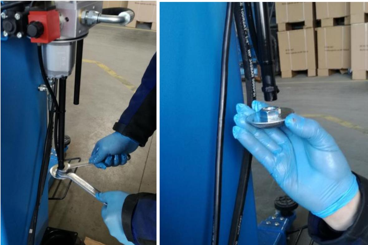
Reinigen Sie mit Drahtbürste und Bremsenreiniger das Gewinde des Ölsaugrohrs.
