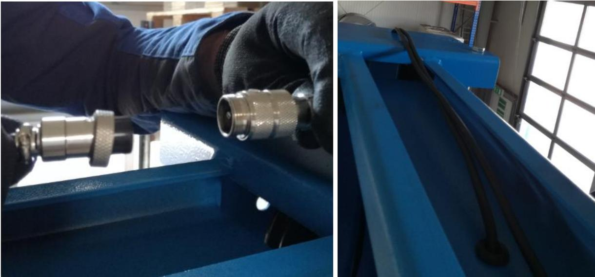
Stecken Sie das Kabel des Enabschalter (Säule), Endabschalter (Traverse), Verlängerungskabel (Spiralkabel Säule 1) und Spiralkabel (Säule 1) durch die Führungslöcher der Säule 2 (Motorseitig)
