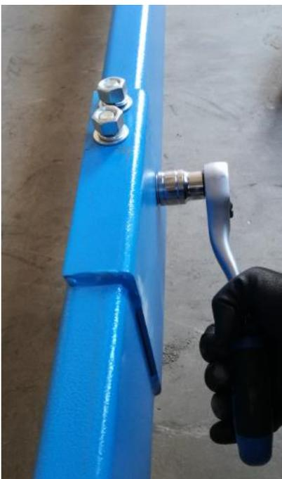
Montieren Sie den Halter für die Enabschalterstange.
