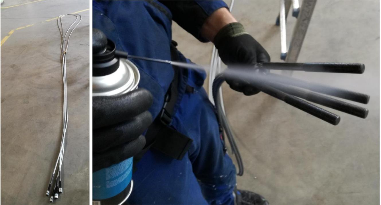
Demontieren Sie die obere Seilabfallsicherung und Seilrolle, schmieren Sie die Seilrolle. Wiederholen Sie diesen Vorgang auch bei der zweiten Seite.
