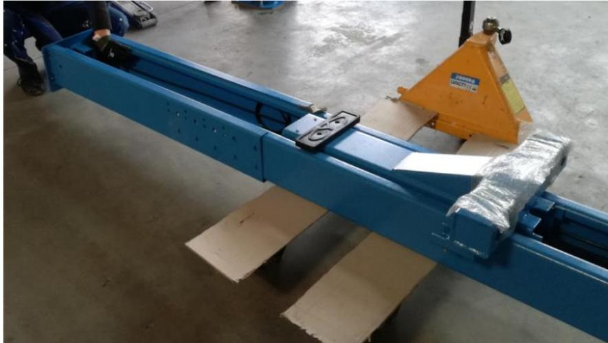
Entfernen Sie die 2 Schrauben an der Säulenverlängerung.
