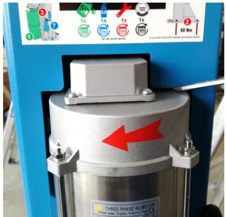
Füllen Sie nun 9,5 Liter Hydrauliköl in den Hydrauliktank.
