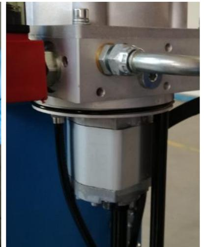
Befestigen Sie nun wieder den Öltank mit den 4 Sechskantschrauben.
