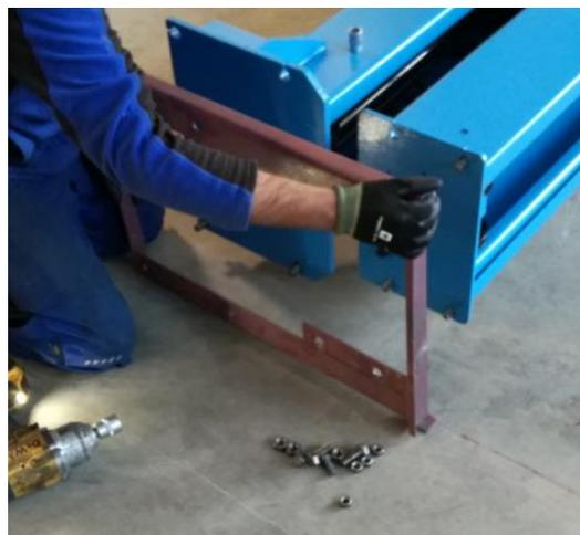
Stellen Sie nun **Säule 1** ab (Unterbacken Sie die Oberseite der Säule mit einem Vierkantholz, um die **Säule 1** später leichter transportieren zu können)
