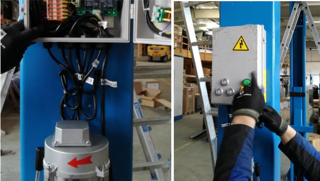
Montieren Sie die Kabelabdeckunghalterung.
