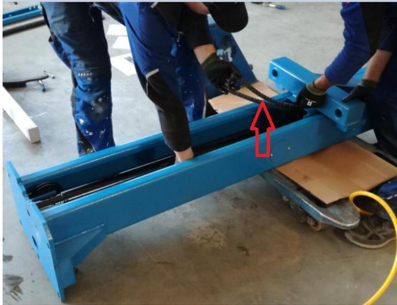
Montieren Sie die Kettenabfallsicherung.
