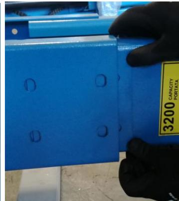
Schrauben Sie die die Säulenverlängerung leicht an sodass die Verlängerung noch bewegt werden kann. Die am Bild rot markierten Pfeile zeigen welche Schrauben jeweils seitlich und an der Rückseite eingeschraubt werden.
