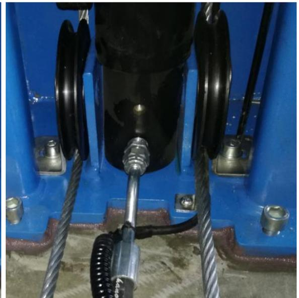
Befestigen Sie das Stahlseil im Schlitten mittels Beilagscheibe und Mutter.
