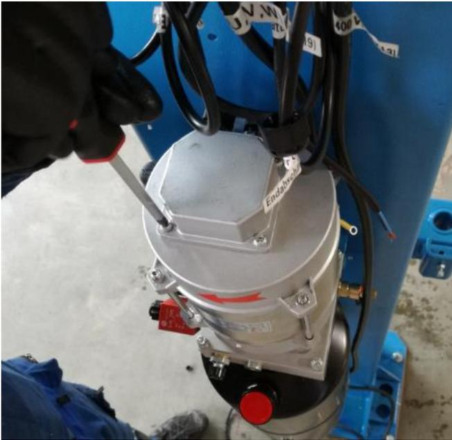
Stecken Sie das Kabel für die Motorstromversorgung (U, V, W) und das Kabel des Motortemperatursensors durch den Kabelausgang der Klemmbrettdeckung.
