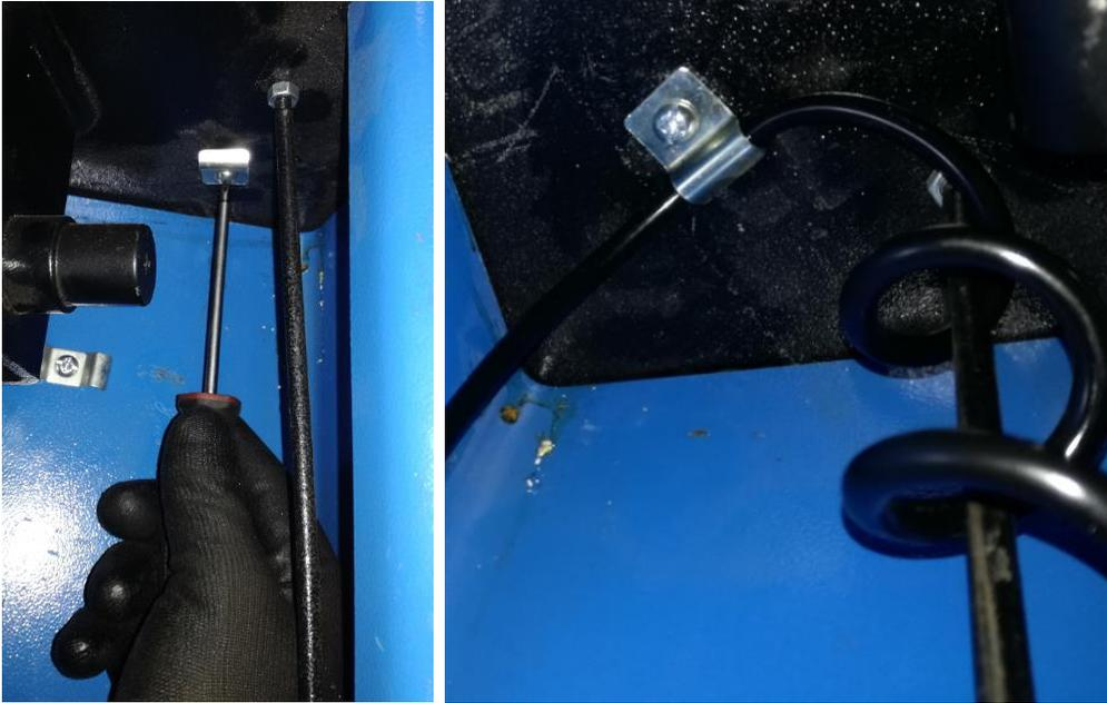
Verlegen Sie die Kabel des Endabschalters und Magnetschalter mit den 2-fach Kabelhalter.
