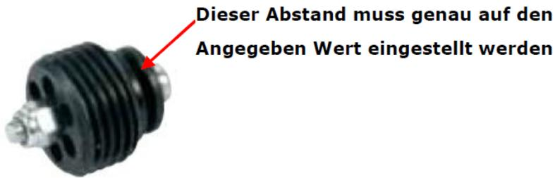
Überprüfen Sie mittels Präzisions – Fühlerlehre den eingestellten Wert. Sollte der falsche Abstand eingestellt sein, vergrößern/verkleinern Sie den Abstand von Beilagscheibe zum Schraubgewinde. Die Fühlerlehre sollte Bündig zwischen Beilagscheibe und Schraubgewinde passen. Achten Sie darauf dass der Abstand an der Beilagscheibe gleich ist und die Fühlerlehre leichtgängig wird – sodass sich der Wert nicht verfälscht
