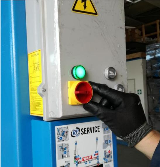
Heben Sie die Hebebühne ganz an bis der Endanschalter den Hebevorgang stoppt.
