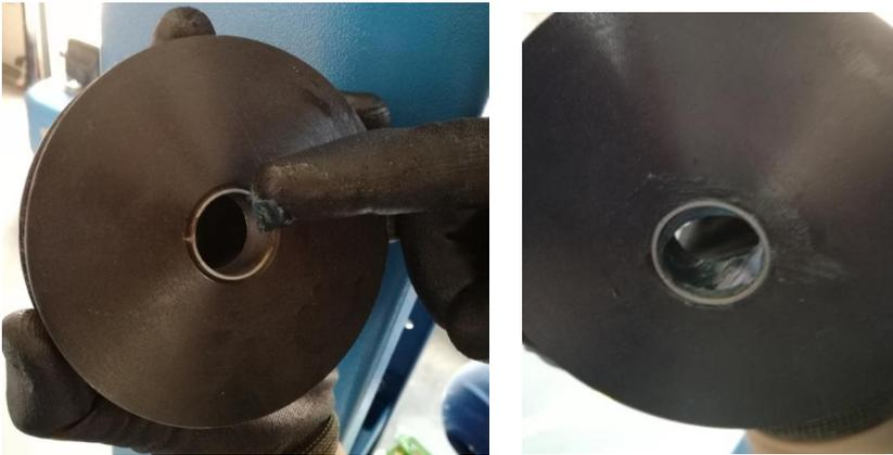
Nachdem die Seilrolle geschmiert wurde, montieren Sie wieder die Seilrolle und ziehen das Stahlseil durch die Rolle, montieren Sie nun wieder die Seilabfallsicherung und fixieren die obere Grundplatte. Wiederholen Sie diesen Vorgang auch an der zweiten Seite.
