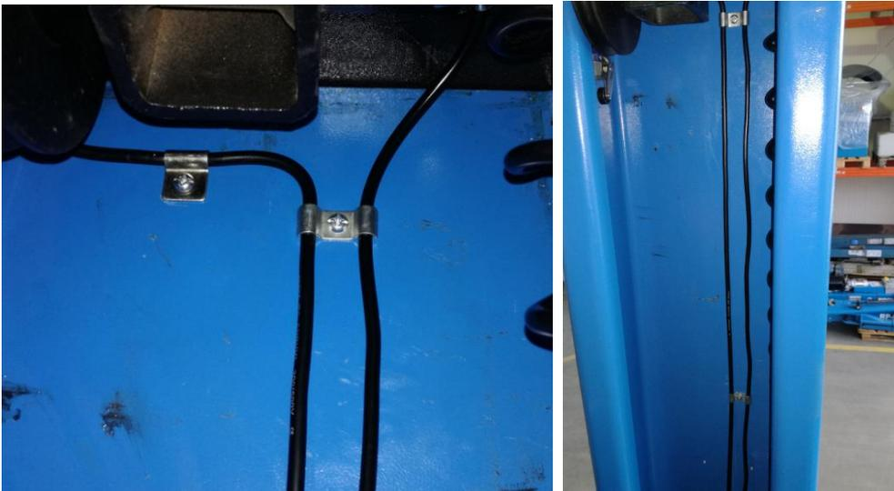
Achten Sie darauf das die Führungsstange der Spiralkabel unter die Seilerolle führt, verbinden Sie danach die Stecker der Spiralkabel.
