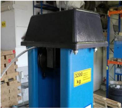
Demontieren Sie die untere Seilrolle und Seilabfallsicherung. Schmieren Sie die Seilabfallsicherung und ziehen das Stahlseil um die Seilrolle. Befestigen Sie nun wieder die Seilrolle. Führen Sie diesen Vorgang auch an der zweiten Seite durch.
