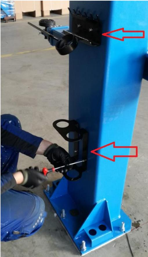
Montieren Sie die Kettenabfallsicherung.
