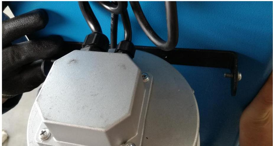
Befestigen Sie die Kabelabdeckung. Achten Sie darauf das die Abdeckung nicht am Motorgehäuse ansetzt.
