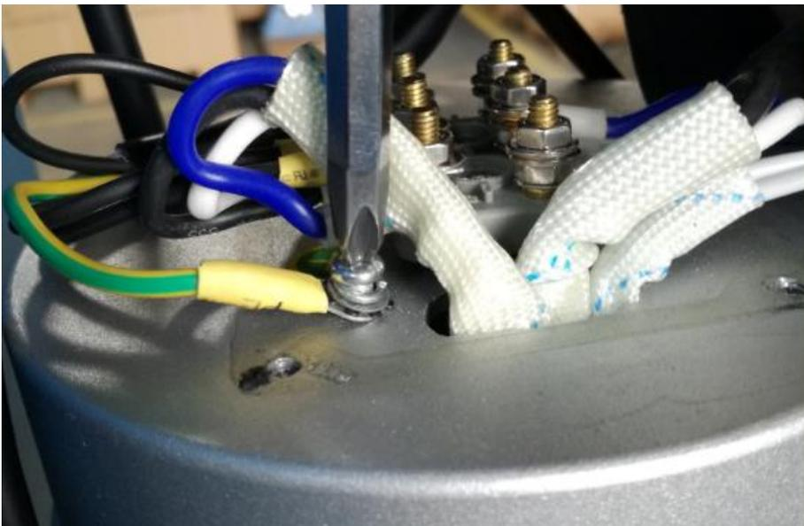
Schließen Sie die 2 Drähte an die Klemme des Motortemperatursensors an.
