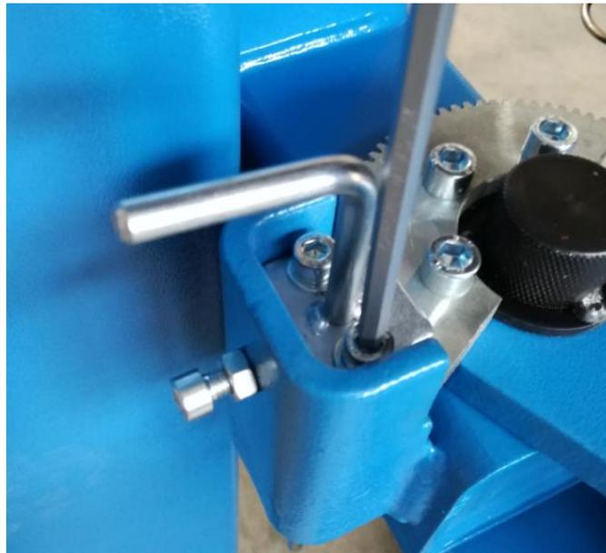
Montieren Sie den Schlagschrauberhalter und Höhenadapterhalter.
