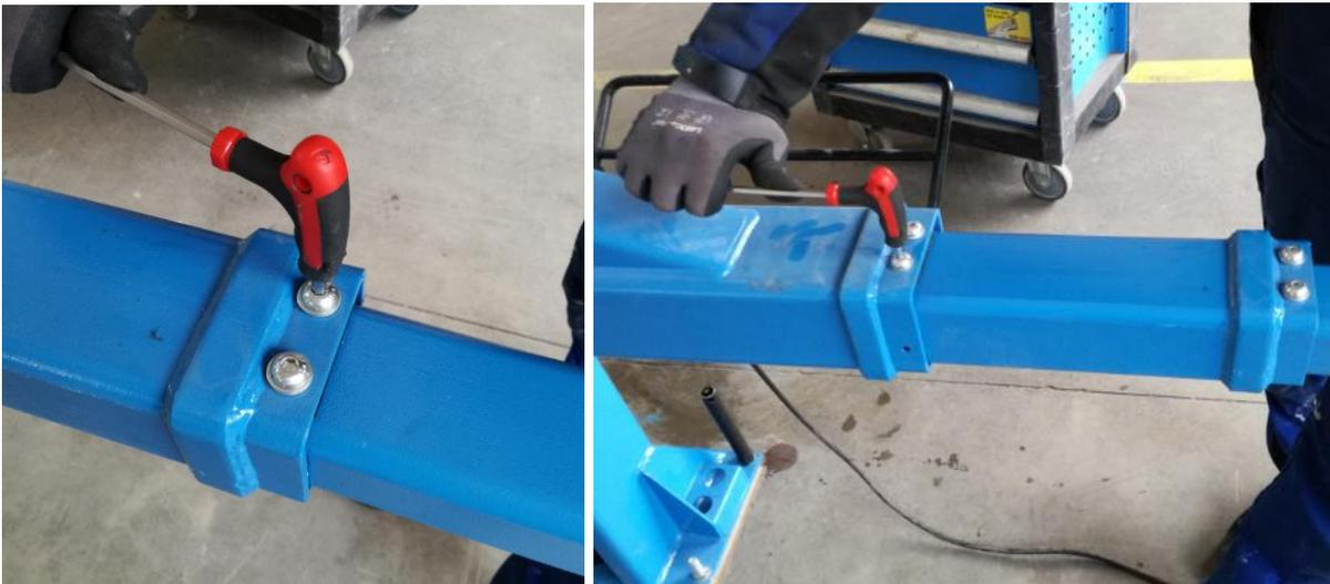
Überprüfen Sie die Armarretierung auf leichte Gängigkeit, stellen Sie diese wenn nötig nach. Ziehen Sie auch die Schraubend des Zahnrastenstück nach. Sollten Zähne der Armarretierung beschädigt sein, erneuern Sie das Defekte Element.
