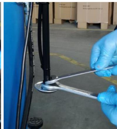
Entfernen Sie nun den alten O-Ring am Hydraulikblock und ersetzen diesen durch den neuen O-Ring.
