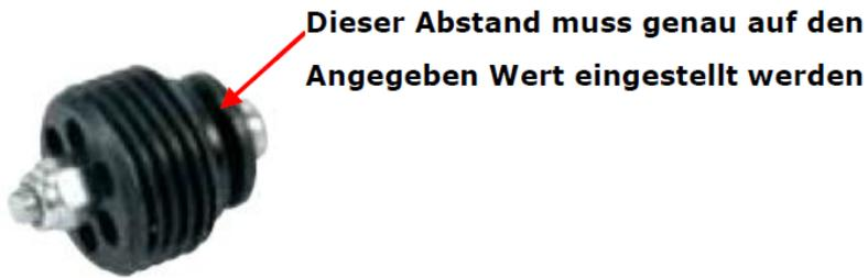
Überprüfen Sie mittels Präzisions – Fühlerlehre den eingestellten Wert. Sollte der falsche Abstand eingestellt sein, vergrößern/verkleinern Sie den Abstand von Beilagscheibe zum Schraubgewinde. Die Fühlerlehre sollte Bündig zwischen Beilagscheibe und Schraubgewinde passen. Achten Sie darauf dass die Abstand rund um die Beilagscheibe gleich ist und die Fühlerlehre leichtgängig wird – sodass sich der Wert nicht verfälscht
