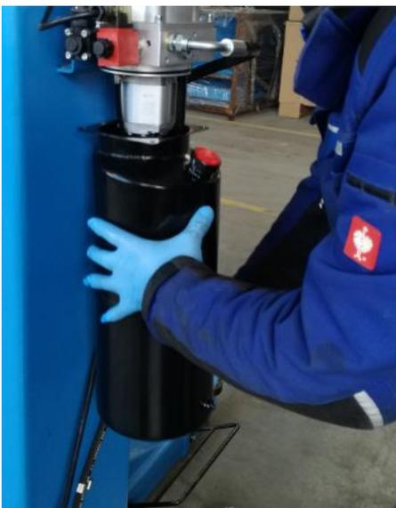
Schrauben Sie die Ölablassschrauben in den Tank und füllen den Tank mit 9,5 Liter Original RP-TOOLS Hydrauliköl.
