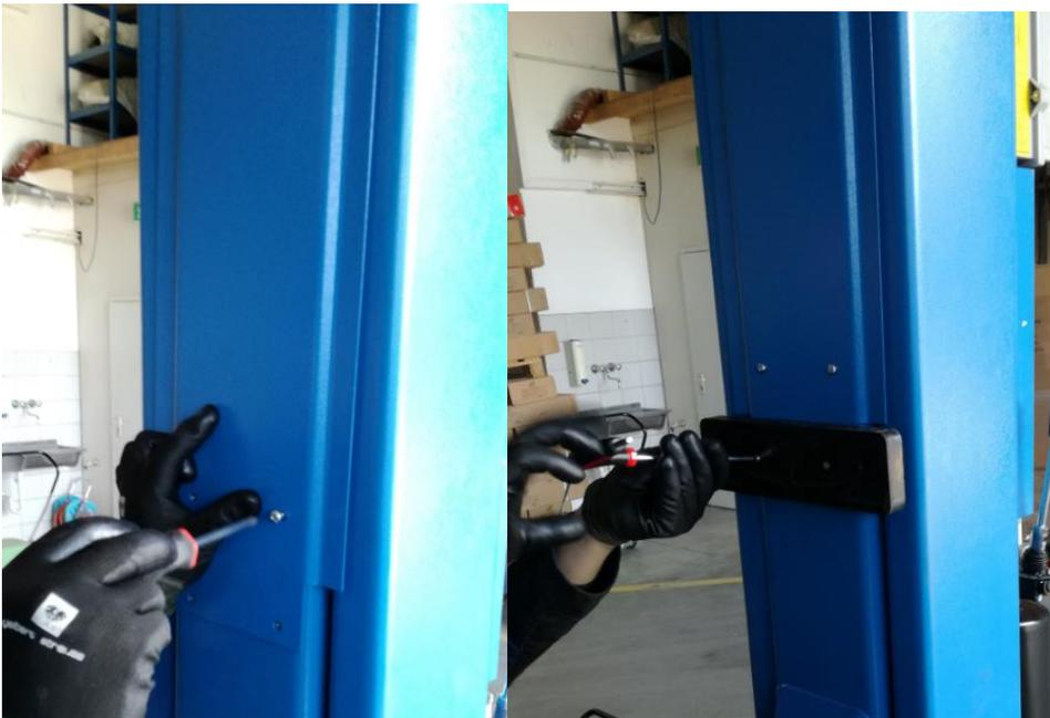
Biegen Sie das Abdeckblech soweit von der Säule weg, sodass das Abdeckblech nicht mehr an der Kunststoffhaube hängen bleiben kann. Wiederholen Sie diesen Vorgang an beiden Seiten.
