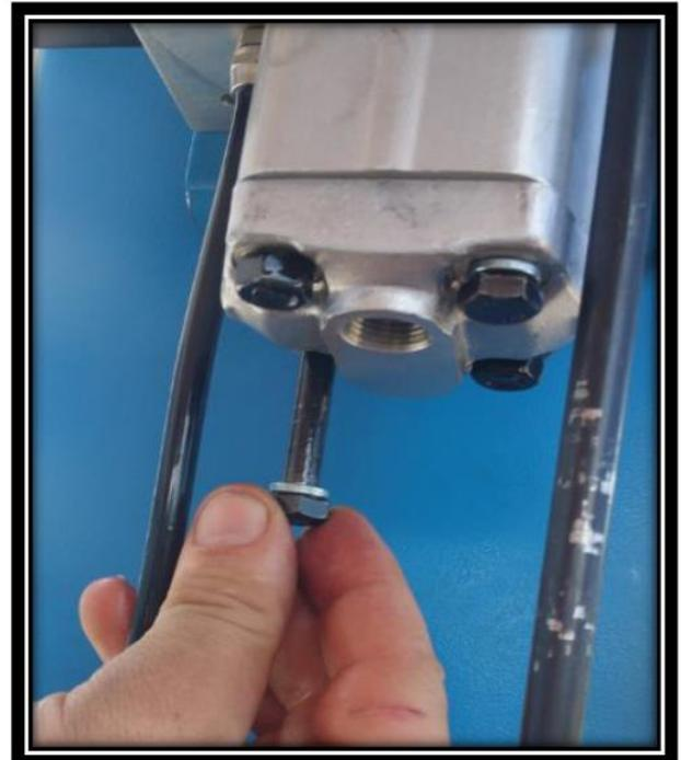
9. (DE) Entfernen Sie die Hydraulikpumpe vorsichtig
