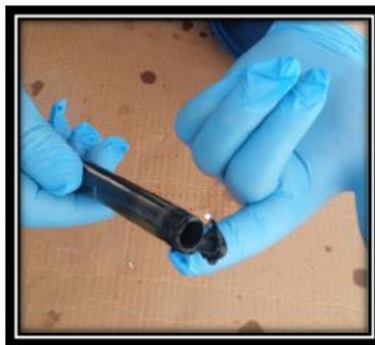
**17.** (DE) Montieren Sie jetzt das Ansaugrohr - Anzugsdrehmoment ca 40 – 50 NM
