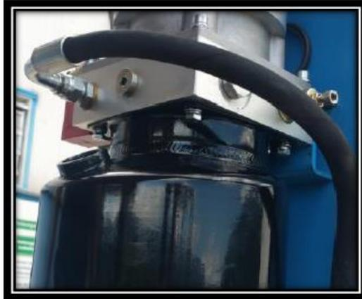
21. (DE) Entfernen Sie die Motor-Abdeckung und schließen Sie alle Kabel zum Motor ab. Achtung!!! Die Kabel müssen wieder so angeschlossen werden, dass die Drehrichtung stimmt.
