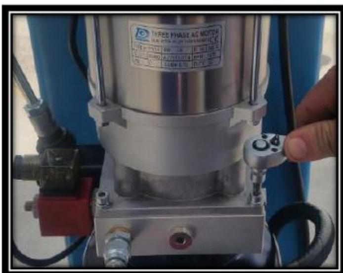
28. (DE) Schließen Sie den Motor wieder so an, dass die Drehrichtung stimmt
