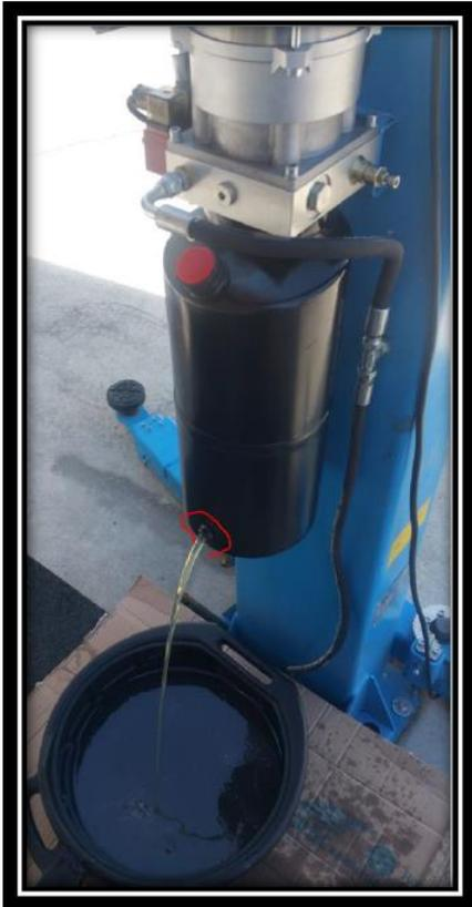
4. (DE) Öffnen Sie die 4 Befestigungsschrauben vom Öltank. **Achtung! Aufpassen, dass der Öltank nicht hinunter fällt.**
